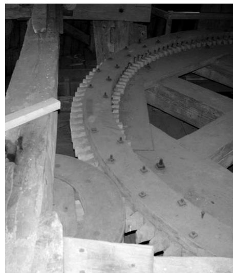
Det imponerende stjernehjul er af en noget anden kvalitet end stokkedrevene. Det er svært at tro, at det skulle være den samme håndværker, der har lavet dem. Et enkelt stokkedrev skiller sig dog ud fra de andre ved at være fremstillet af mere gedigne materialer.
